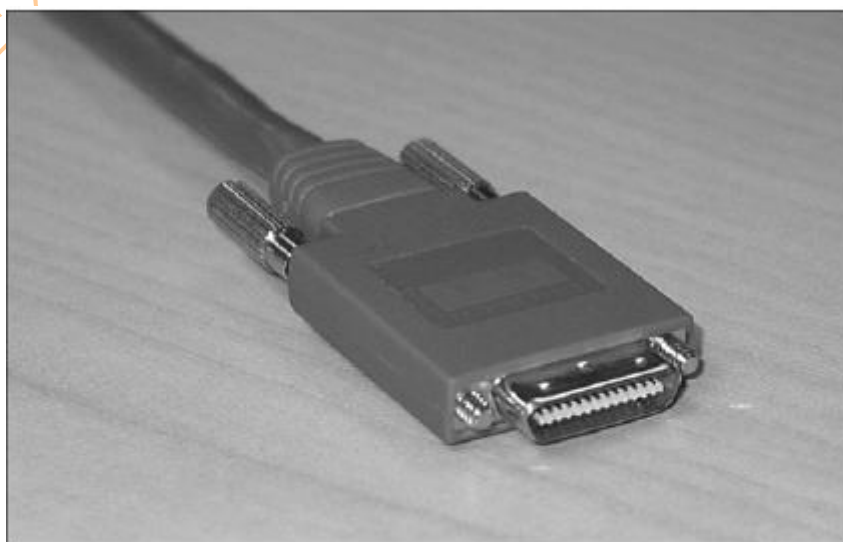
Hình 1-4: Cáp Smart Serial (1700, 1800, 2600, 2800).
