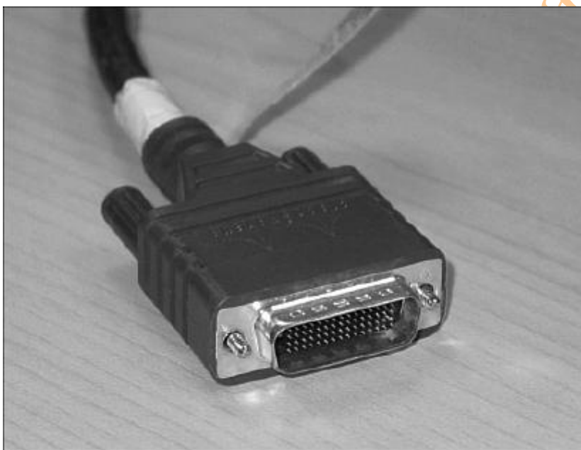
Hình 1-3: Cáp Serial (2500)
